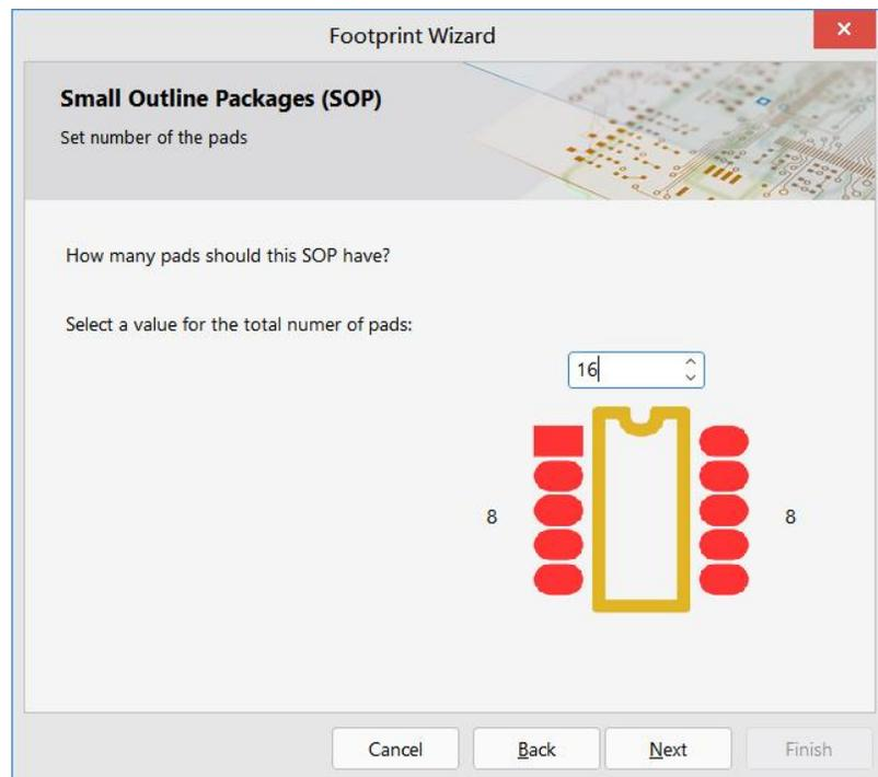
图2-38 集成电路块的外形设置界面2
