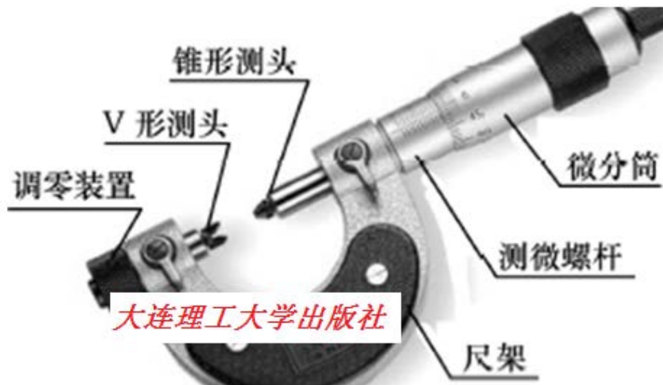
螺纹千分尺的结构
