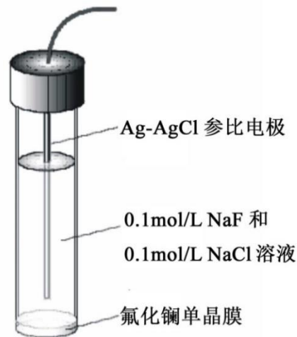
图3-4 氟离子选择电极基本结构
