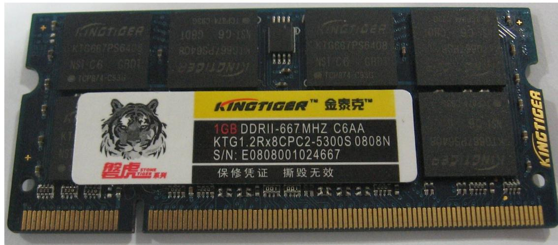
图1-21 多层板实物图
