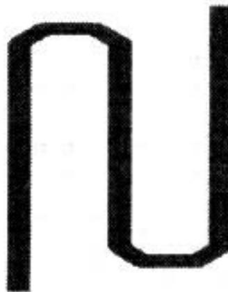
图1-55 导线串扰处理
