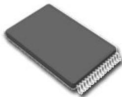
图1-30 TSOP封装
